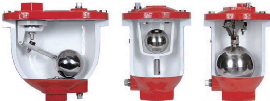
图 15 典型排气阀(来源: Mueller Water Products Inc.)
