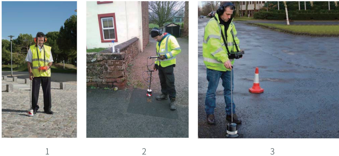
图 32 电子听漏仪(来源: EPAL (Lisbon)(1), K Atkinson(2), S Hamilton(3))
