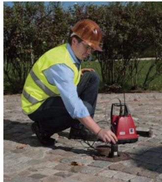
2 吸附在阀门上的加速度传感器
