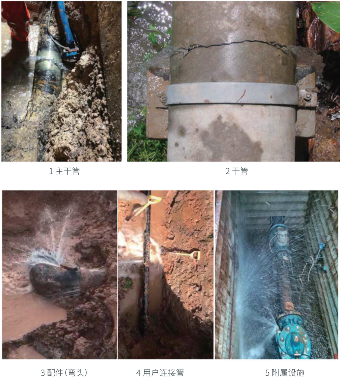
图 26 典型泄漏(来源: Severn Trent Water(1,3,4,5), K Atkinson(2))
